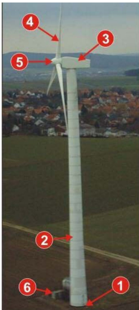
Slika . Izgled vetrogeneratora sa opisom pojedinih delova
